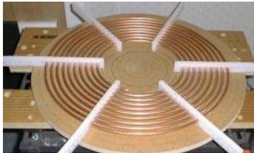
内圈接头部分，将中密度底版在相应地方开孔引出一个接头如图：
