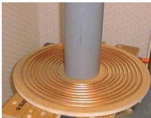
这样盘成的主线圈可以适用于 6 英寸到 8 英寸的次极线圈（盘铜管很费时间，也满费劲，但是不要图快，要尽可能盘的圆滑。），还需要 5 毫米厚的软塑料板（非脆性塑料）做主线圈支架，将其按等距离打眼（要打成 9 毫米的眼，要不穿不进去）底座选用普通中密度板就可以了，这个底座还有用，将来底下要放其它东西。也尽可能加工好，接下来把铜管和塑料支架穿起来。
