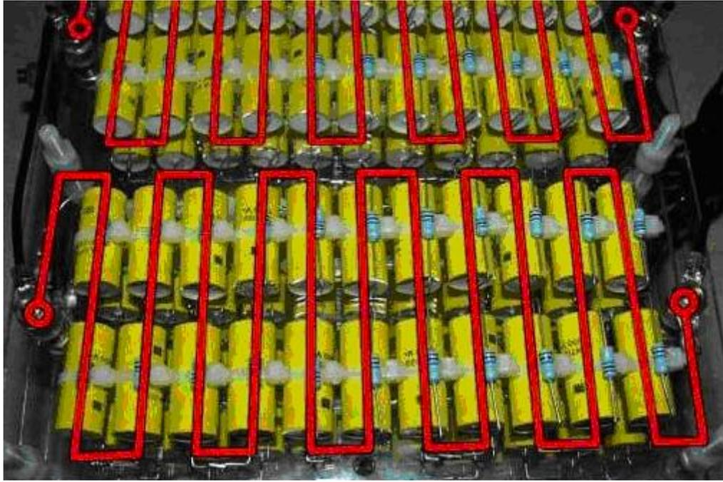
注意！电容之间不要紧密接触！要留有一定空隙，层与层之间要用 4mm 厚的有机玻璃隔离，每层包含两个链，固定使用塑料螺丝（一般都叫尼龙螺丝），每层都有各自的接口使之成为独立可使用的单元，如图：
