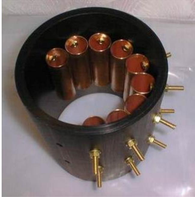
为了根据需要调整放电缝隙，每相伶螺栓代表 1mm 的放电缝隙（螺栓即为接线柱）这样安装只要变换接线柱就可以很方便的根据你的设计电压进行调整了。
