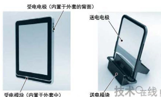
图 4：电力传输需要使用两组电极
