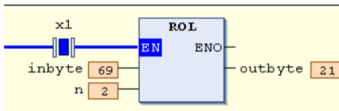
分析：在本例中，inbyte 和 outbyte 分别设为 byte 数据类型，inbyte=10#69，n=2。当 X1 为 TRUE 时，ROL 执行循环左移位，此时 inbyte=10#69=2#01000101，循环左移 2 位后，outbyte=2#00010101=10#21。
