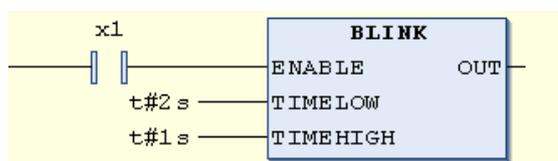
分析: 在本例中, 当 ENABLE X1 是 TRUE 时, BLINK 开始工作, 输出低电平 2s 高电平 1s 的脉冲, 如下图。
