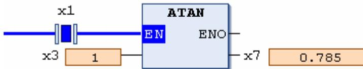
分析：在本例中，X3=1 弧度=180/pi 度；当 X1 为 TRUE 时，ATAN 执行反正切运算，将 X3 的反正切值输出到 X7 中，所以 X7=0.785。
