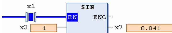
分析：在本例中， $X3=1$  弧度 $=180/\pi$  度；当  $X1$  为 TRUE 时，SIN 执行正弦运算，将  $X3$  的正弦值输出到  $X7$  中，所以  $X7=0.841$ 。
