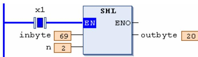
分析：在本例中，inbyte 和 outbyte 分别设为 byte 数据类型，inbyte=10#69，n=2。当 X1 为 TRUE 时，ROL 执行左移位，此时 inbyte=10#69=2#01000101，左移 2 位后，outbyte=2#00010100=10#20。
