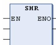
SHR (in, n)。in: 需要右移的操作数。n: 操作数右移的位数。如果 n 超出了数据本身的位数，BYTE、WORD 和 DWORD 类型的操作数将会补 0，而有符号类型的操作数（例如 INT）将会进行算术移位。也就是说会将这些数的最高位的值补在空出的二进制位上。
