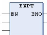
两个操作数可以是 BYTE、WORD、DWORD、INT、DINT、REAL、SINT、USINT、UINT、UDINT 类型。输出变量只能是 REAL 类型。
