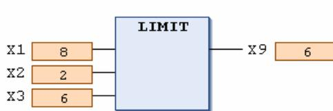
分析: Max 是结果的上限值, Min 是结果的下限值。如果 IN 值大于上限值 Max, LIMIT 将返回 Max, 而如果 IN 小于 Min, 那么结果为 Min。在本例中, 当  $X1 < X2 < X3$  时, 输出  $X9 = X2$ ; 当  $X2 < X1 < X3$  时, 输出  $X9 = X1$ ; 当  $X1 > X3 > X2$  时, 输出  $X9 = X3$ 。
