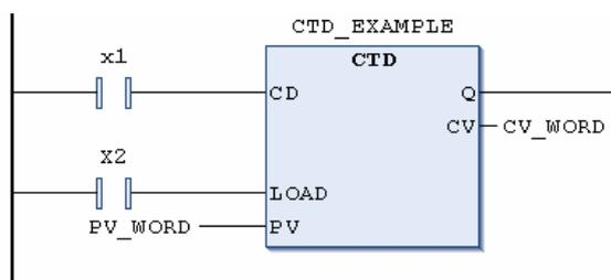
分析: 程序执行时, 将 PV\_WORD 设为 3, 当 X2 由 FALSE 变为 TRUE 上升沿触发时, CV\_WORD 也变为 3。此时输入端 X1 执行 FALSE 变为 TRUE 上升沿触发, 则 CV\_WORD 自动减计数 1; 当 X1 第 3 次由 FALSE 变 TRUE 上升沿触发时, CV\_WORD 递减到 0 时, 此时 Q 输出为 1。
