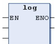
输入变量可以是 BYTE、WORD、DWORD、INT、DINT、REAL、SINT、USINT、UINT、UDINT 类型。输出变量只能是 REAL 类型。
