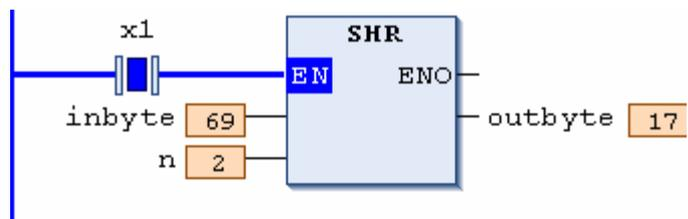
分析：在本例中，inbyte 和 outbyte 分别设为 byte 数据类型，inbyte=10#69，n=2。当 X1 为 TRUE 时，ROR 执行右移位，此时 inbyte=10#69=2#01000101，循环右移 2 位后，outbyte=2#00010001=10#17。
