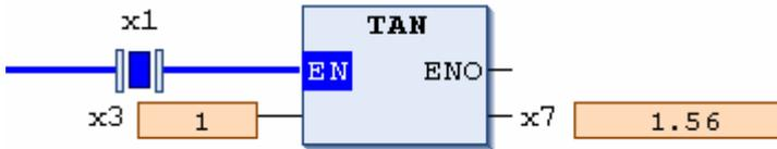
分析：在本例中，X3=1 弧度=180/pi 度；当 X1 为 TRUE 时，SIN 执行正切运算，将 X3 的正切值输出到 X7 中，所以 X7=1.56。
