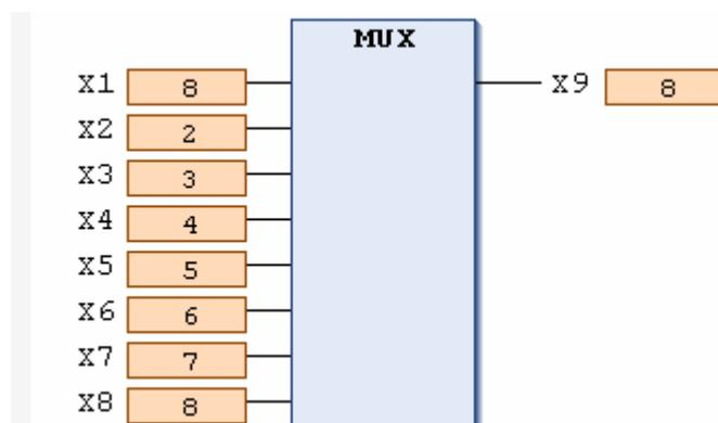
分析: 在本例中, MUX 指令根据 X1 的值, 来决定 X9 的输出值。当  $X1=8$  时, MUX 取功能块中的第 8 个值, 即  $X9=X8=8$ 。
