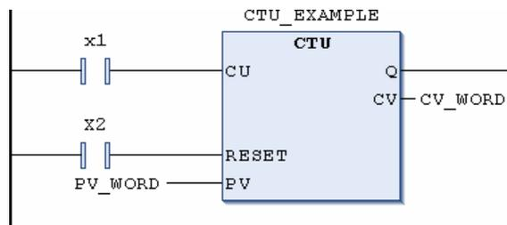
分析: 程序执行时, 将 PV\_WORD 设为 3, 此时 CV\_WORD 是 0。此时输入端 X1 执行 FALSE 变为 TRUE 上升沿触发, 则 CV\_WORD 自动加计数 1; 当 X1 第 3 次由 FALSE 变 TRUE 上升沿触发时, CV\_WORD 递增到 3 时, 此时 Q 输出为 1。此时如将 RESET 端 X2 执行 FALSE 变为 TRUE 上升沿触发, 则指令重新复位数变量 CV 被初始化为 0。
