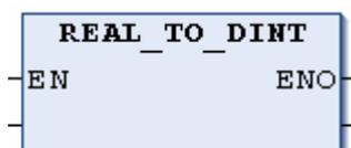
数值将被四舍五入为近似的整数值，然后转换成新的变量类型。请注意转换为字符串类型时，（长）实数的位数不能超过 16 位。如果位数太多，那么第十六位将被四舍五入。如果定义的字符串长度比较短，那么数字的右侧部分将被截去。
