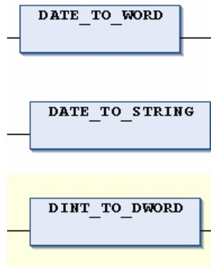
日期以秒为单位，用 DWORD 数据类型从 1970 年 1 月 1 日起存储在内部。然后再进行转化。从较大的数据类型转换为较小的数据类型时，有可能丢失部分信息。转换为字符串类型变量时，转换结果为日期常量。
