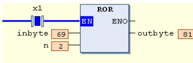
分析：在本例中，inbyte 和 outbyte 分别设为 byte 数据类型，inbyte=10#69，n=2。当 X1 为 TRUE 时，ROR 执行循环右移位，此时 inbyte=10#69=2#01000101，循环右移 2 位后，outbyte=2#01010001=10#81。
