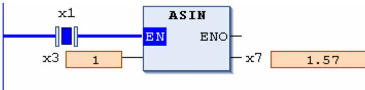
分析：在本例中，X3=1 弧度=180/pi 度；当 X1 为 TRUE 时，ASIN 执行反正弦运算，将 X3 的反正弦值输出到 X7 中，所以 X7=1.57。
