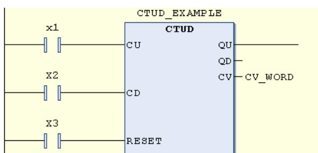
分析：当 RESET 为 TRUE 时，计数变量 CV 被初始化为 0。当 LOAD 为 TRUE 时，计数变量 CV 被初始化为上限值 PV。当 CU 端有一个从 FALSE 变为 TRUE 的上升沿时，CV 将加 1。当 CD 端有一个从 FALSE 变为 TRUE 的上升沿时，若 CV 不会降到 0 以下时，它将减 1。当 CV 大于或等于上限 PV 时，QU 返回 TRUE。当 CV 等于 0 时，QD 返回 TRUE。
