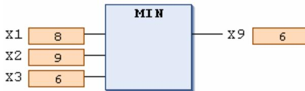
分析：程序运行时，MIN 指令取输入的 X1,X2,X3 中最小的值，并将结果输出到 X9 中。在本例中 X3 最小，因此 X9=X3=6。
