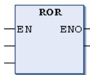
ROR (in, n)。允许的数据类型：BYTE、WORD、DWORD。in 将会右移二进制位 n 次，同时右边移出的位将会重新补充到左边。
