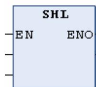
SHL (in, n)。in: 需要左移的操作数。n: 操作数左移的位数。如果 n 超出了数据本身的位数，BYTE、WORD 和 DWORD 类型的操作数将会补 0，而有符号类型的操作数（例如 INT）将会进行算术移位。也就是说会将这些数的最高位的值补在空出的二进制位上。
