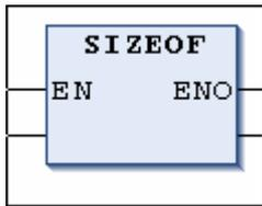
SIZEOF 操作符通常返回一个无符号数。返回值的类型与变量 x 的大小相匹配。
