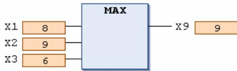
分析：程序运行时，MAX 指令取输入的 X1,X2,X3 中最大的值，并将结果输出到 X9 中。在本例中 X2 最大，因此 X9=X2=9。
