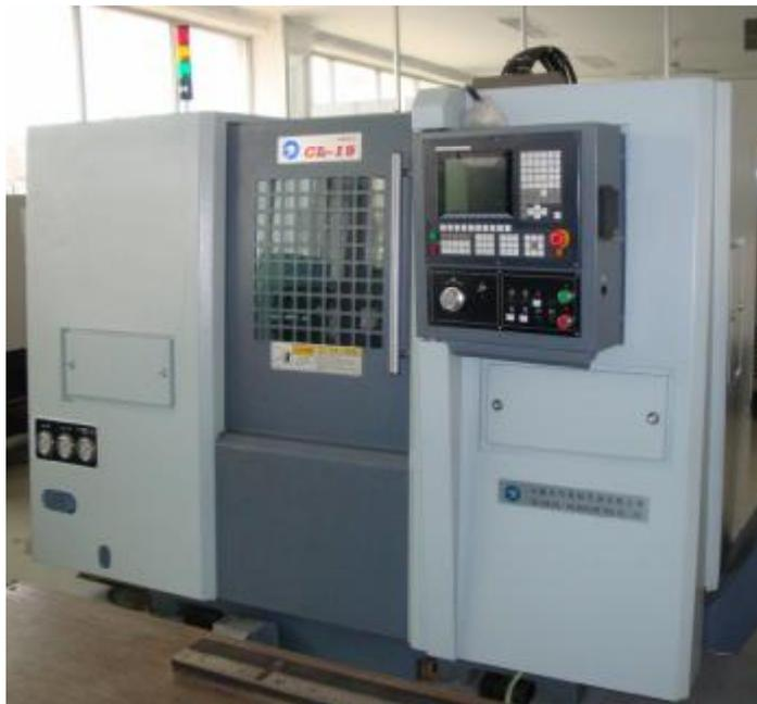
CL 系列的全机能数控机床是具有两轴联动、半闭环控制的数控机床。机床具有高刚性的结构设计和吸震性，以保证高精度的切削加工。对控制进给轴 X、Z 轴的伺服驱动器及电机要求有高的动态响应特性及精确的定位精度，使机床的刀架移动快速、稳定且定位精度高。
