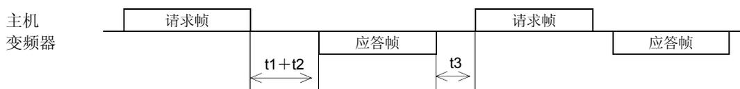
$t_1+t_2$  : 变频器的应答时间
