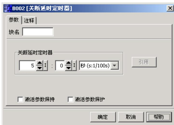
块属性对话框包含多个选项卡。每个块都有一个注释选项卡，您可以从中输入相关的块注释。有些块还有参数选项卡，您可以从中说明特定的块参数。输入仿真参数在仿真选项卡中进行配置。
