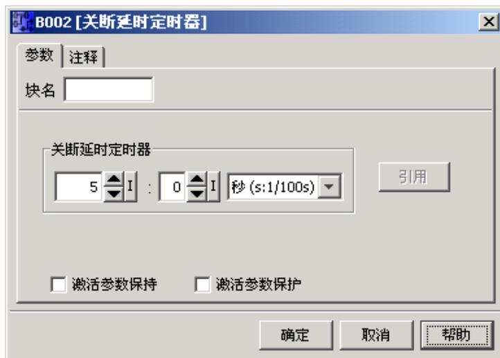
在仿真模式下，将为您显示实际的参数值。该分析选项使您能够测试电路程序的反应。您可以在仿真模式下同时打开多个参数分配窗口。
