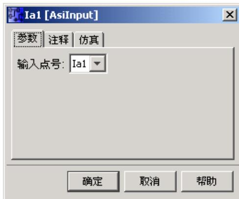
AS-i 接口输入名为 Ia。AS-i 接口输入的块编号由硬件结构确定。
