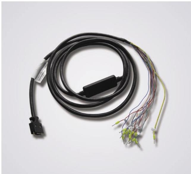
SIMATIC PLC/SINAMICS V80通讯电缆是为SIMATIC PLC与SINAMICS V80之间进行信号交换定制的专用电缆。电缆中部的集成电路中包含了信号优化所需的电阻以及源型、漏型PLC选择电路。通过这根电缆，将SIMATIC PLC与SINAMICS V80组成一个全新的可靠的系统。
