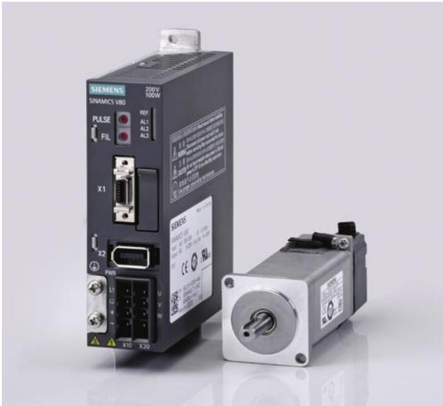
SINAMICS V80伺服驱动系统包括伺服驱动器和伺服电机两部分，伺服驱动器总是与其对应的同等功率的伺服电机一起配套使用。SINAMICS V80伺服驱动器通过脉冲输入接口来接受从上位控制器发来的脉冲序列，进行速度和位置的控制，通过数字量接口信号来完成驱动器运行的控制和实时状态的输出。
