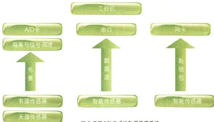
图3 采用多种方式的数据采集系统
