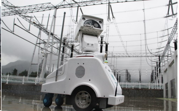
图A3 巡检机器人现场调试、执行巡检和顺控配合
