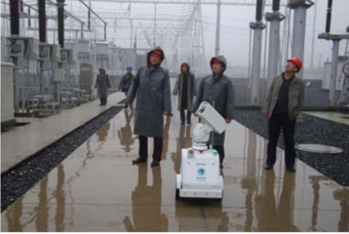
图A3 巡检机器人现场调试、执行巡检和顺控配合
