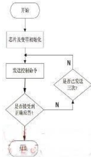
图 4 主机程序的流程图
