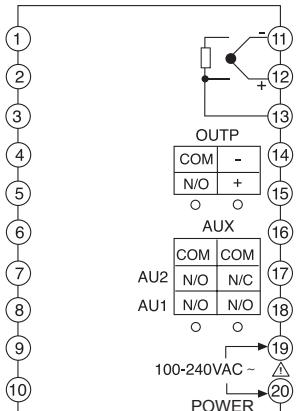
注: 本图为 A、C、E 端式面板的仪表接线图。
