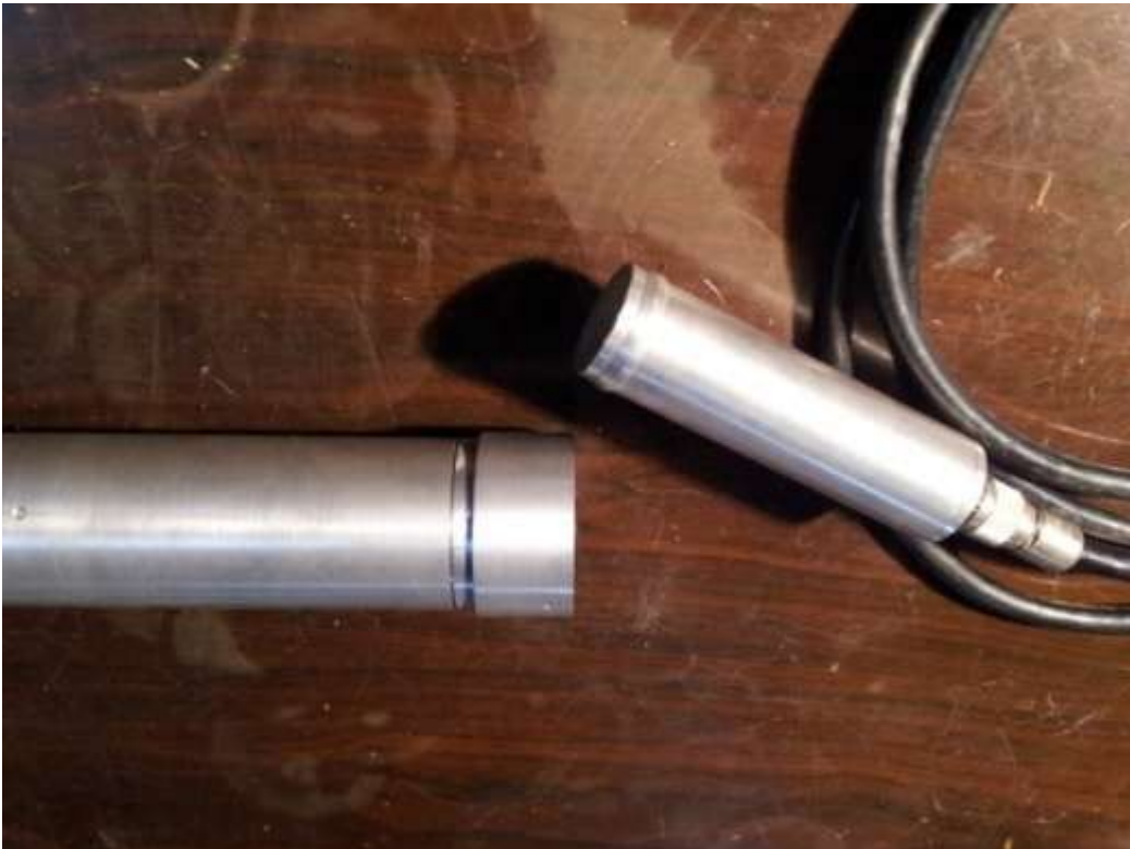
图 3 天线端口的非接触快插同轴连接器
