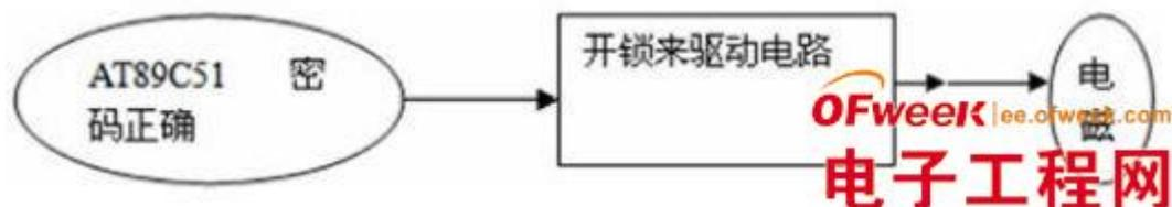
根据上面的图形可知,当用户在规定的的时间和输入次数内输入的密码正确时,单片密码锁便输出开门的信号,将信号传送到驱动开锁的电路,进而驱动电磁锁,实现开门。
