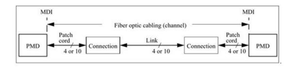
再来看第三个原因,这个原因更加现实,即原有大家熟悉的光纤连接头,例如 SC,LC 无论从芯数上和小型化上均无法满足这个高速网络标准中定义的 MDI 多芯的要求。另外要想在现场完成这样单根光纤的多芯连接的工作显得非常困难,因为一芯的不合格意味着整根不合格。同时很难得到性能的完整保障和也很难满足性能一致性的要求。那么把现场如此复杂的工作转移到专门的具有流水线和多种设备的工厂去做是一个必然的选择。虽然这样做对传统的数据中心布线系统有些挑战,主要表现在设计阶段和现场勘查计算阶段,需要确定每个机柜位置并计算出每条 Trunk 光缆的精确长度,以便工厂预定生产。但这点工作对这种满足高速网络的高性能的光纤布线系统以及现场施工带来的可能的性能不确定性而言实在算不了什么。其实这也是改变我们传统布线思维模式的一个锲机。其实很多行业产品均可以在工厂预制好。玩具行业里的乐高,家具行业里的宜家可能已经早就领会了这一思想。
