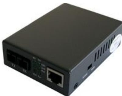
上图的产品是 10/100M 自适应快速以太网光纤收发器。它可以实现双绞线和光纤两种不同传输介质的转换，中继 10/100Base-Tx 和 100Base-FX 两个不同网段，能满足远距离、高速、高带宽的快速以太网工作组用户的需要。
