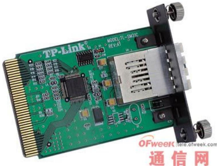
千兆系列光纤模块卡，是与交换机配合使用，使用光纤或五类双绞线传输，可扩展局域网范围，扩大带宽，适合于大、中型局域网在扩大带宽、扩展其网络覆盖范围时使用。该光纤模块完全符合 IEEE802.3z 协议，工作于 850nm、1300nm 模式；也完全符合 IEEE802.3ab 协议，兼容其他相同千兆协议的设备，由于体积小，直接安装于交换机内部，不需额外占用空间，由交换机内部供电，安装使用简便，可配合多款交换机使用。
