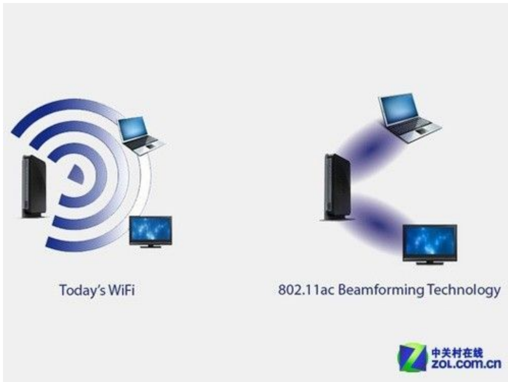
未采用波束赋形技术的信号示意图（左）和采用波束赋形技术的信号示意图（右）
