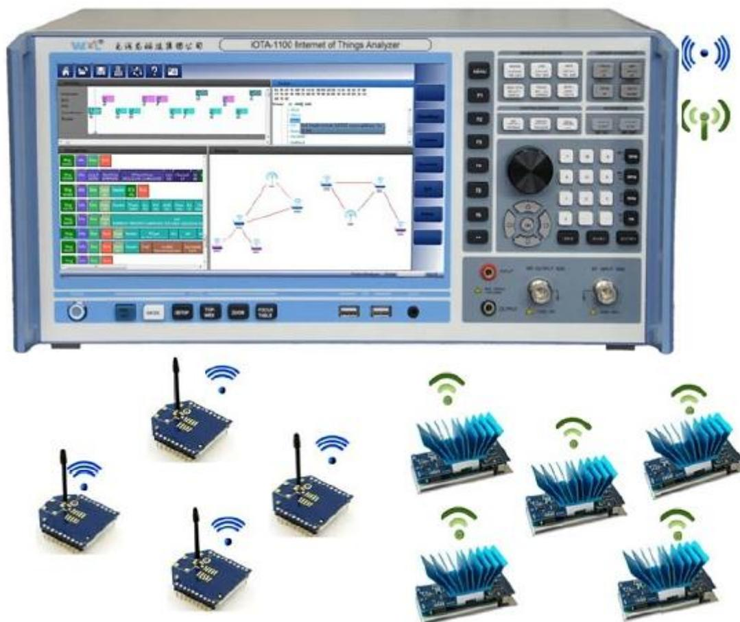
图 1：2 个独立的 ZIGBEE 传感器网络空中协议采集和分析演示。
