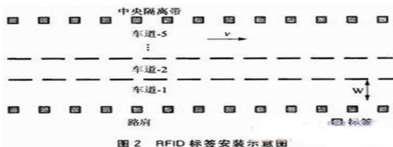
图 2 RFID 标签安装示意图
