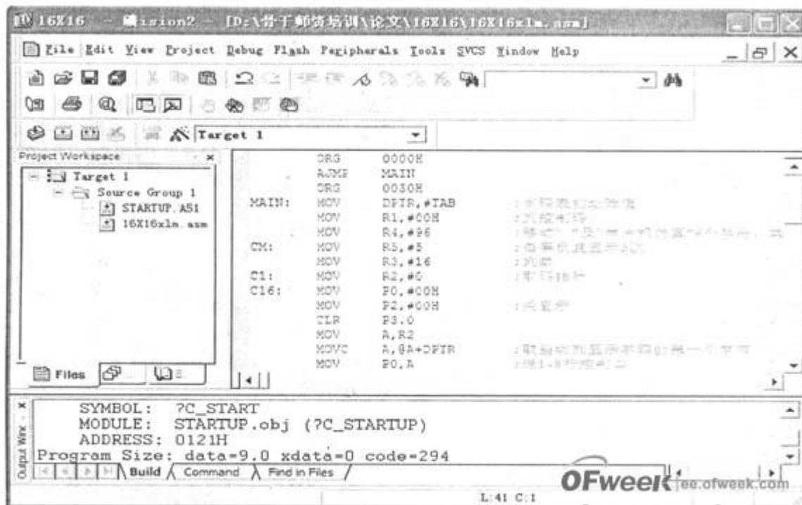
图5 在keil软件中编程和调试
