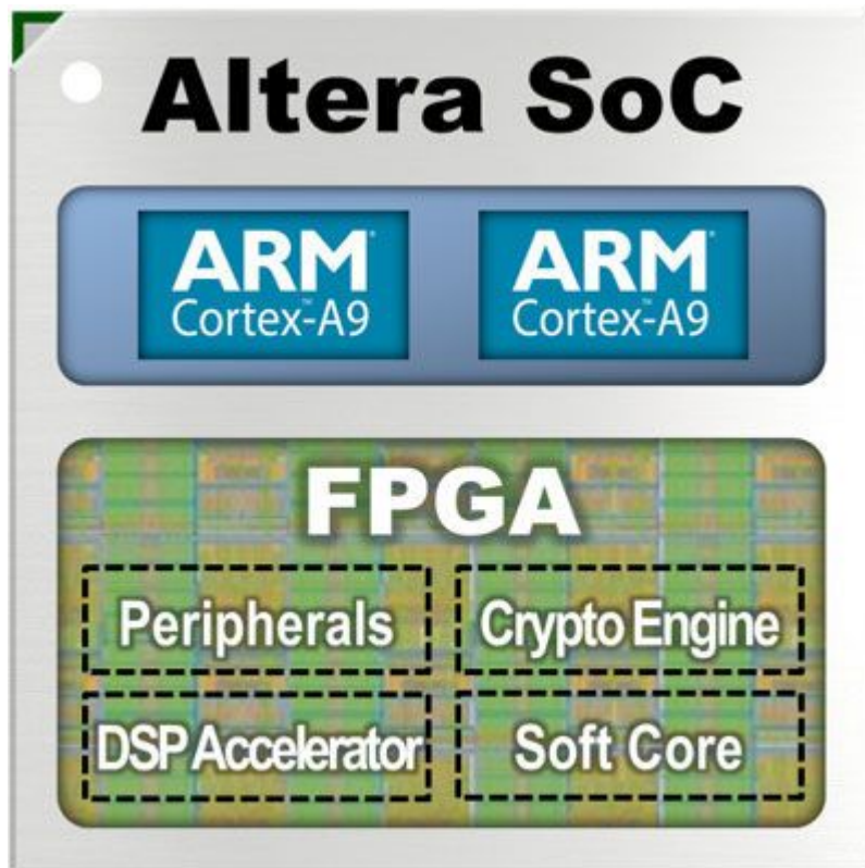
图 1.Cyclone V SoC, FPGA 和处理器之间>100 Gbps 互联
