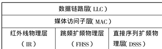
图 1 IEEE802.11b 协议体系结构
