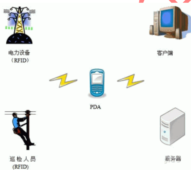
图 2 基于 RFID 的智能电网系统结构
