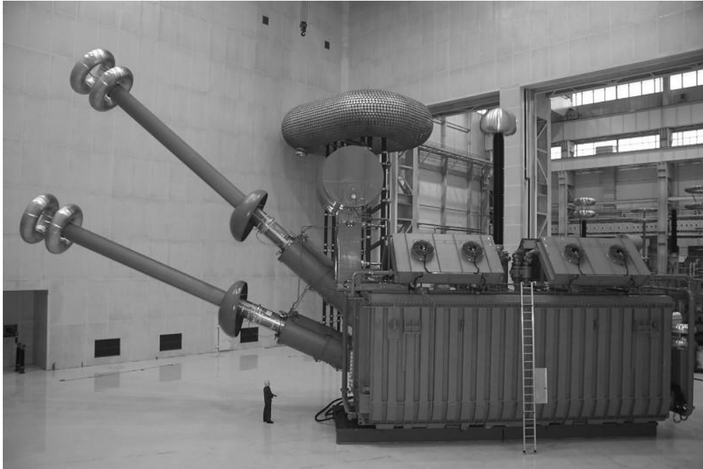
天威保变为云广特高压直流输电工程制造的±800KV 特高压换流变压器
