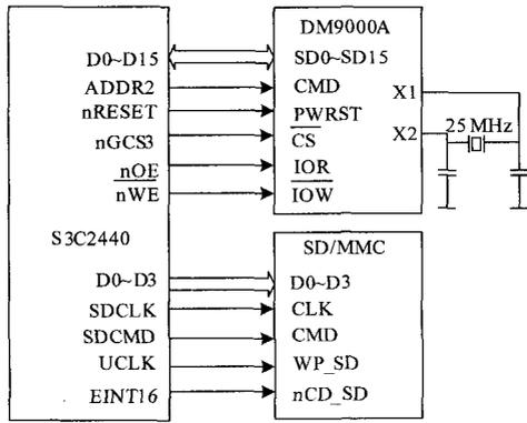
图 6 ARM 与 SD 卡和网络电路示意图
