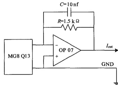
图 3 电流互感电路示意图
