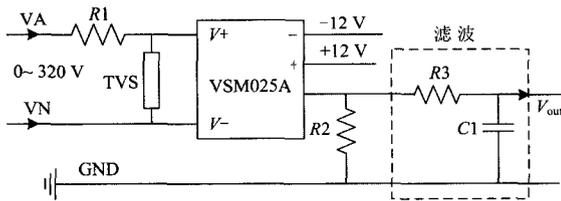
图 2 电压互感电路示意图
