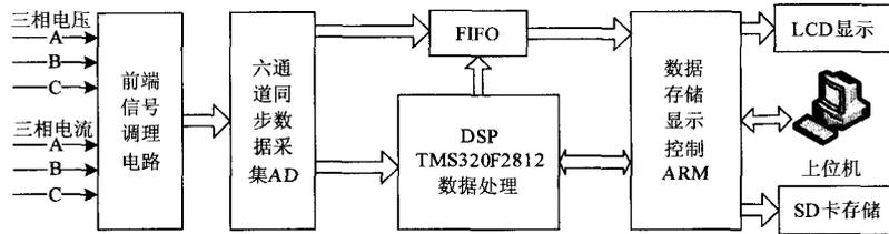
图 1 系统硬件系统结构图
