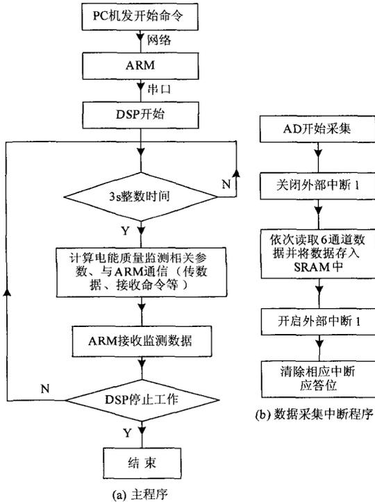
图 7 DSP 程序流程图
