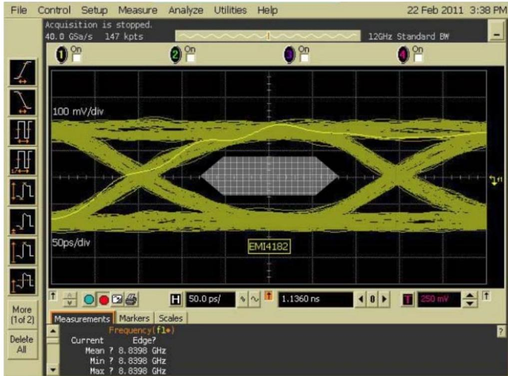
图 5: 安森美半导体 EMI4182 硅共模滤波器在 HDMI 1.4 环境下的信号完整性演示。
