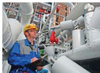
农特里茨工厂多晶硅生产中的循环气装置。工艺产生的副产品在装置中进行回收，重新加入到生产工艺中。
