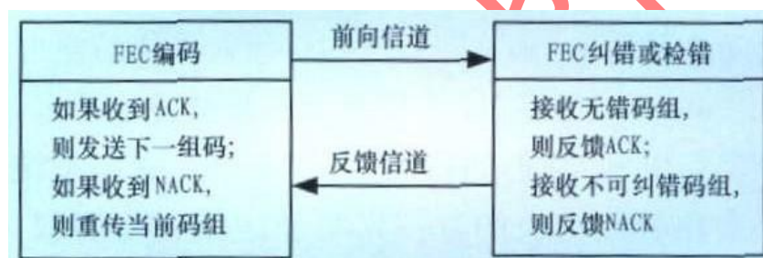
图 3 HARQ 系统原理
