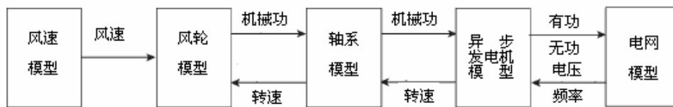
图 3 恒速风力机仿真模型的总体结构
