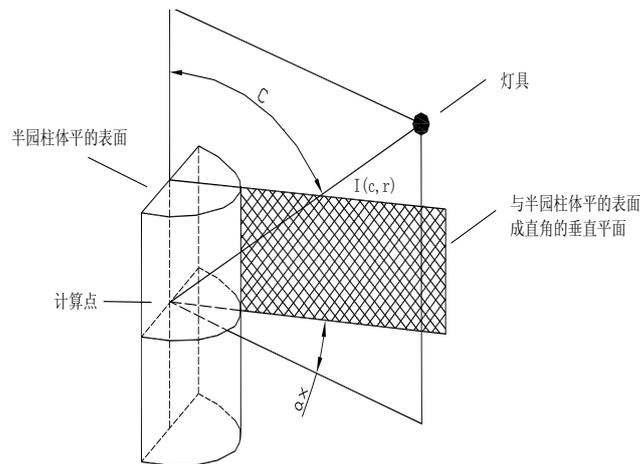
图 B. 0. 1 计算半柱面照度时所用的角
