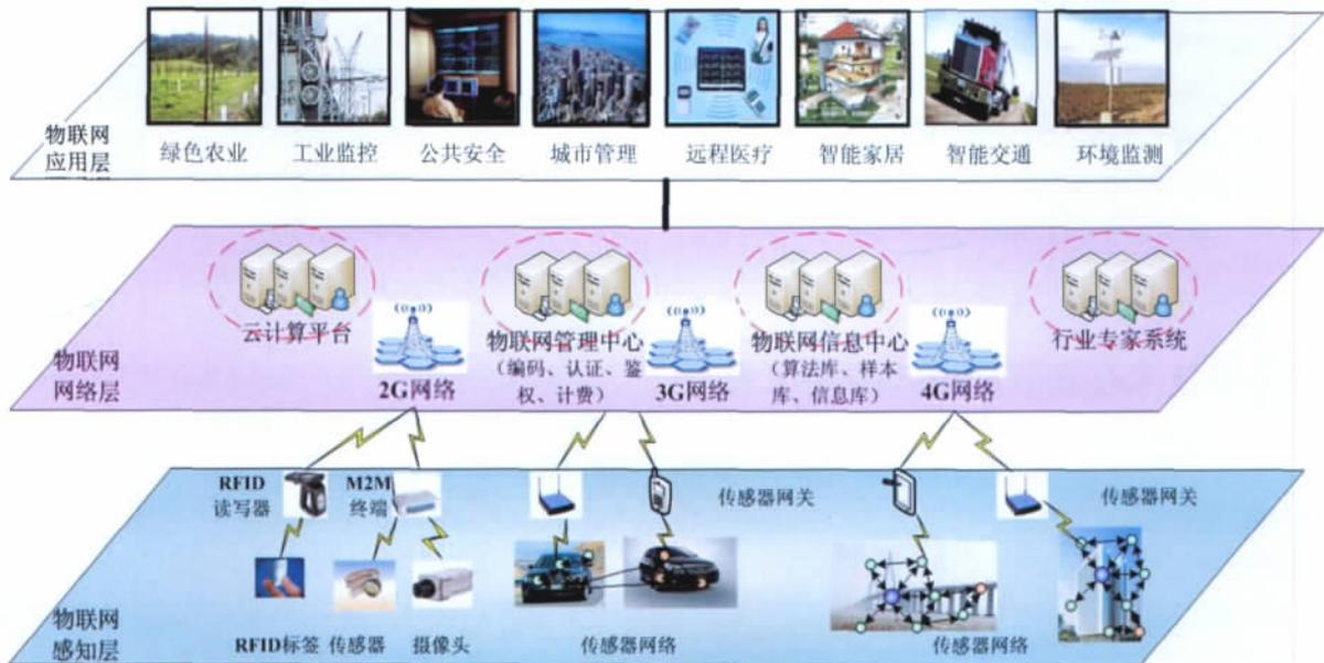
图1 物联网的体系架构
