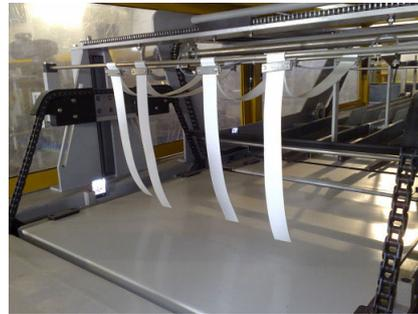
转移输送机和推瓶链
