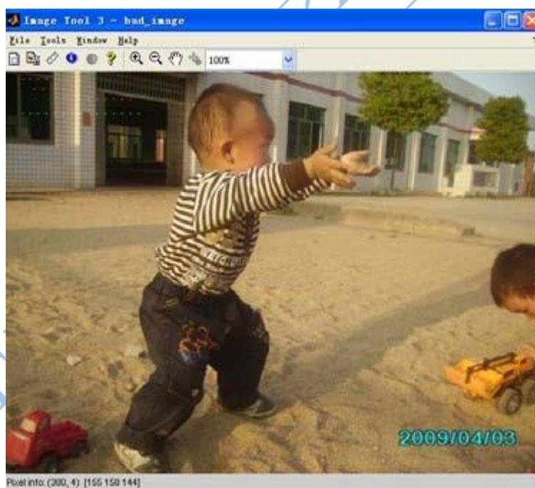
▲图 5 (b) 由 Bayer 数据未作坏点修正直接复原出的图像
