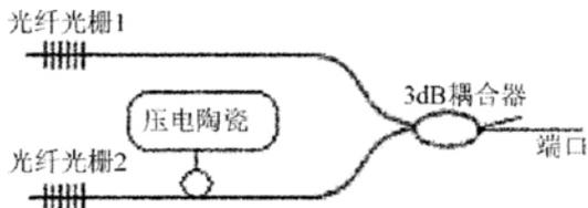
图 3 光纤迈克尔逊干涉仪调 Q 装置
