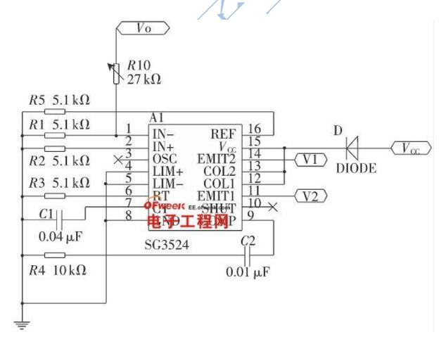
1)输出脉冲频率是工作频率,由\*脚到接地端的定时电阻 RT 和 7 脚连到地的电容器 CT 决定,频率值为
