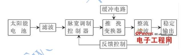
由图 1 可见,太阳能电池输出的直流电压经滤波除掉噪声干扰后,由脉宽调制控制器实现脉宽调制。经推挽变换器和滤波电路后输出直流电压。输出电压与反馈控制电路进行比较,如输出电压为 14V,可直接对蓄电池充电;如小于 14V,则经升压电路升压至 14V 后对蓄电池充电,由此可保持电源持续工作。
