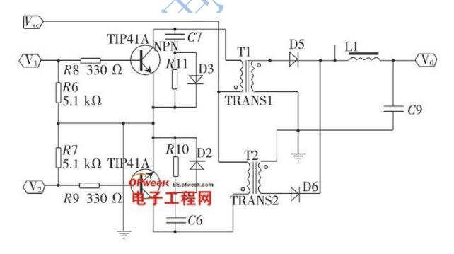
对推换电路进行仿真,结果如图 5 所示。由图可知,开关管在关断瞬间会产生很高的电压尖峰脉冲,反向恢复过程中也会出现很高的反向恢复电压尖峰脉冲。这是由开关电源电路中变压器的漏感,布线的引线电感和输出整流快速恢复二极管的存储效应引起的。因此,必须在功率器件两端设置尖峰电压吸收电路。
