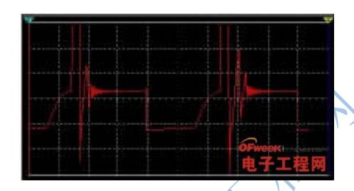
经反复实验调试,确定吸收电路的电容 C=1nF,电阻  $R=100\Omega$ ,再次对该电路进行仿真,结果如图 6 所示。与图 5 进行对比发现,加入缓冲电路前产生的脉冲尖峰消失,说明设计的缓冲电路能很好地吸收脉冲尖峰,抑制了噪声。
