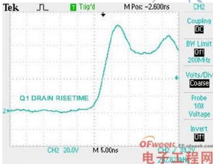
图 8. 漏极电压上升时间
