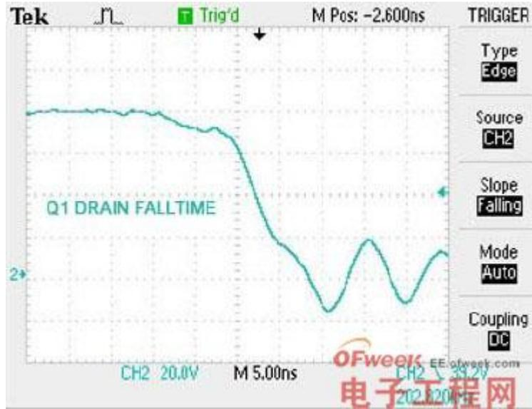
图 9. 漏极电压下降时间
