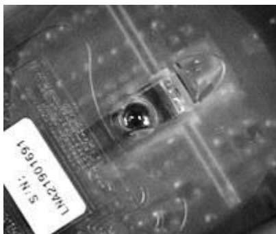
图 6 光电鼠标的背面外上的壳圆形透镜很像一个摄像头
