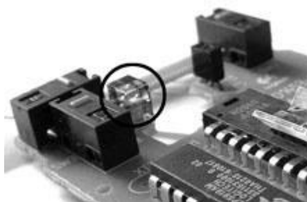
图 9 光电“发射/接收”装置
