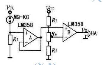
图 1 中,R1 是传感器要求的负载电阻,阻值为 120 Ω,Vcc 为 9 V 电源电压;A、B 为 LM358 双运放,A 为跟随器,起缓冲隔离作用,以便将 R1 上的电压 VR1 基本上全部施加到比较器 B 的同相输入端。RW 为报警灵敏度调整电位器。稳态时,调整 RW 使得加到比较器反相输入端的电压 V-略高于稳态时 R1 上的电压 VR1 这个电压越高,报警灵敏度就越低。加电并使传感器达到稳态后,MQ-KC 为较稳定的固定阻值,当 Vcc 不变时,VR1 基本为一固定值,保持不变。当有可燃性气体泄露时,传感器接触到可燃气,使其电导率上升,电阻下降,使 VR1 上升,当 VR1 高于 V-时,比较器输出一个大于 7 V 的电压,从而使蜂鸣器 HA 发出滴、滴的报警声。若用该电压控制一个继电器,即可实现控制功能。为了提高抗干扰能力,可分别在 R1 和 B 的 V-端并联一只滤波电容。
