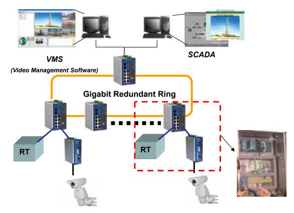
视频网络应用在项目中发挥了主要作用,通过现场的实际视频图像帮助 SCADA 管理员监控现场情况。视频管理软件用于显示视频图像,当操作员面对紧急情况时也可以通过 SCADA 服务器显示这些视频图像。通过图像,操作员可以立刻知道现场发生的事情,并就如何处理现场问题做出正确的决定。
