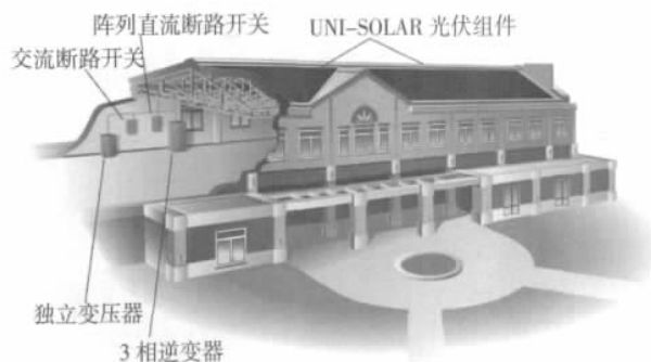
图 7 柔性太阳能薄膜系统
