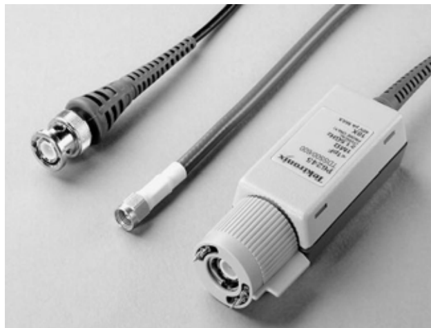
图 2.1. 必需提供各种连接器类型的探头，以与不同的示波器输入通道连接器相匹配。
