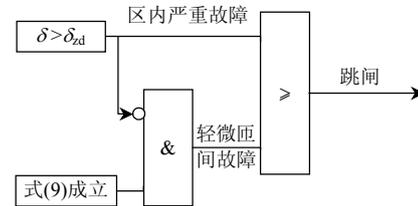
图 5 基于瞬时 T 型等效电路模型的变压器保护跳闸逻辑
