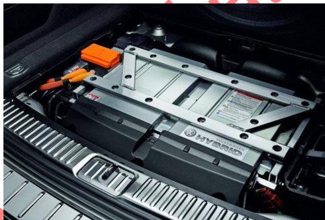
大众的 Hybrid 版途锐所使用的电池即为镍氢电池
