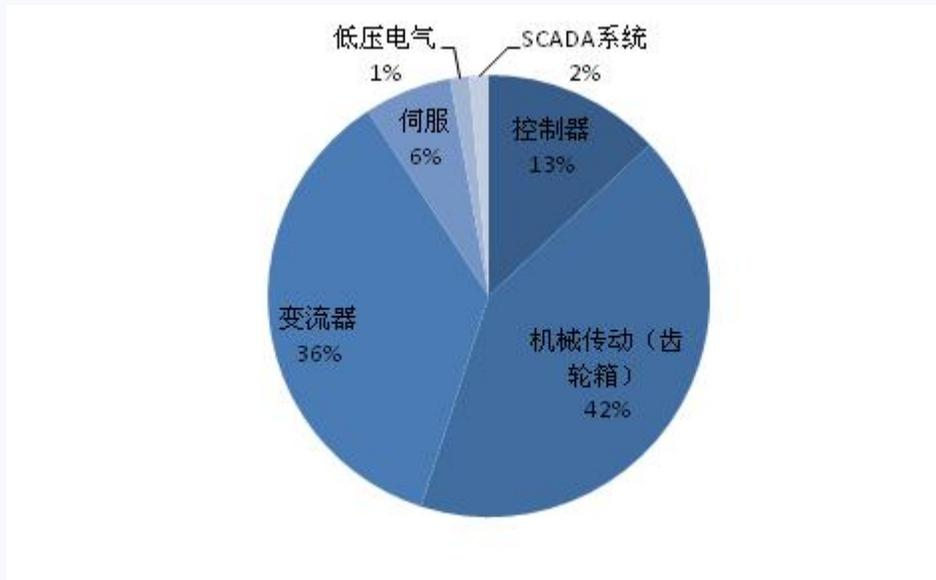
齿轮箱、变流器以及伺服产品在风力发电机组成本中占比例较大。
