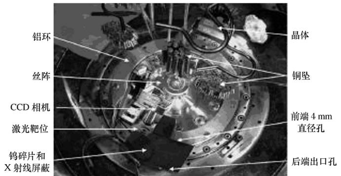
图 2 激光背光照相诊断布局照片(Z 装置靶室内)
