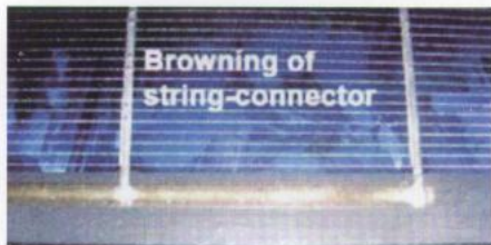
图2 热循环试验导致电池片焊带颜色变化、连接失效
