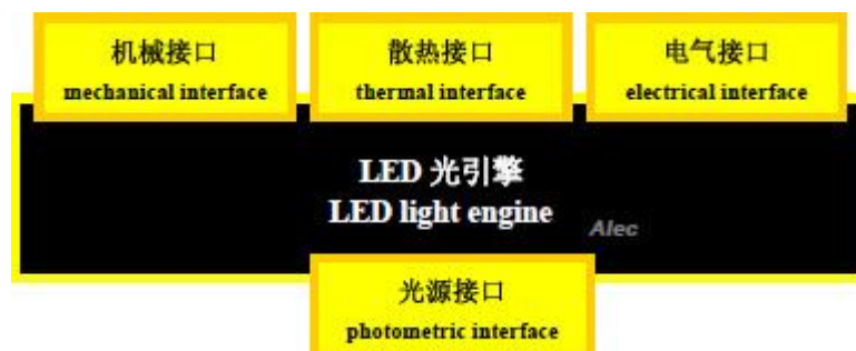
图 1 ZHAGA 联盟推动 LED 光引擎介面接口标准
