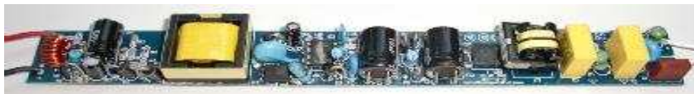
图4 隔离式LED日光灯电源的照片
