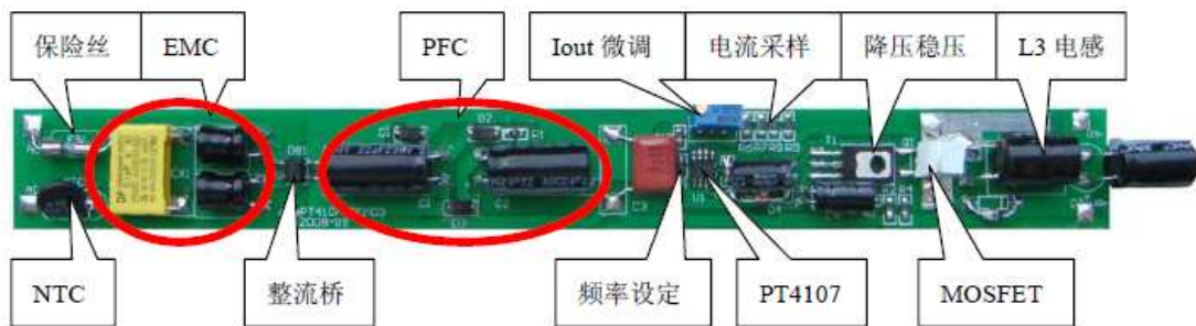
图 2. 非隔离降压式恒流源的外形照片
