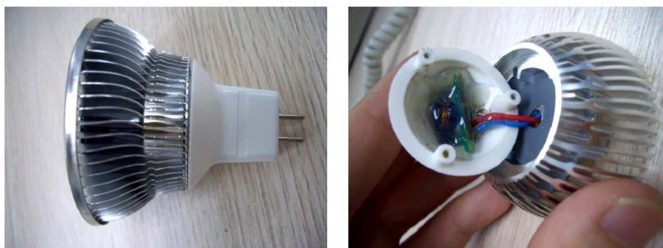
图 5：微型 LED 驱动板可以嵌入灯座内
