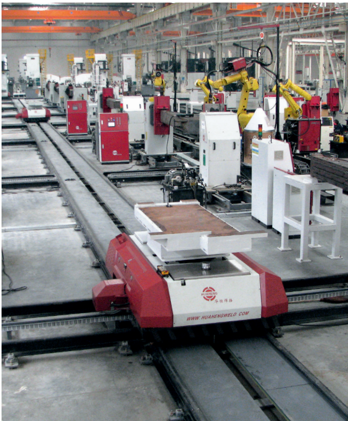
全自动化物流生产线由五个部分构成：轨道、作为运输工具的RGV搬运小车、一个机器人工作站、分散控制系统和上位控制系统。
