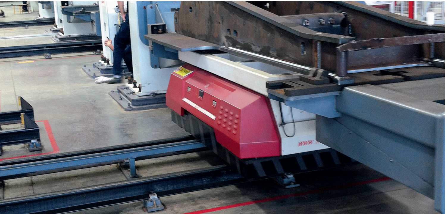
RGV 小车在三一临港生产基地的结构件焊接车间中用于全自动生产挖掘机挖斗和动臂
