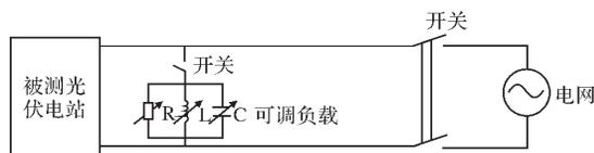
图6 60 kW 光伏电站防孤岛效应保护试验接线图
