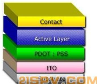
双分子层有机光伏电池架构
